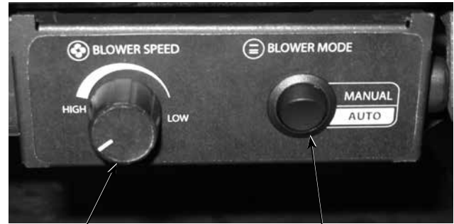
Blower Speed Control Knob (rheostat)
