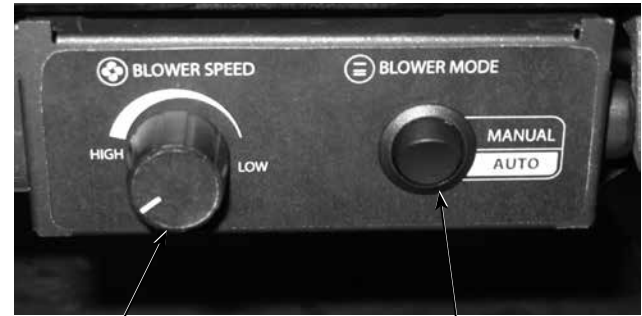
Blower Speed Control Knob (rheostat)
