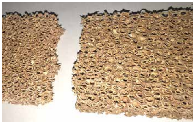
Problème avec le catalyseur - Catalyseur cassé
