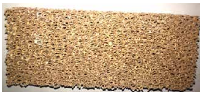
Problème avec le catalyseur - Catalyseur fissuré
