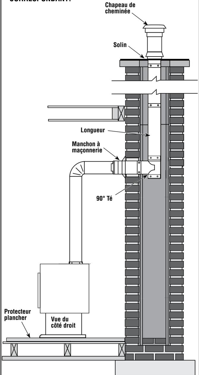
**Figure 7 - Connecté à une cheminée en maçonnerie**
