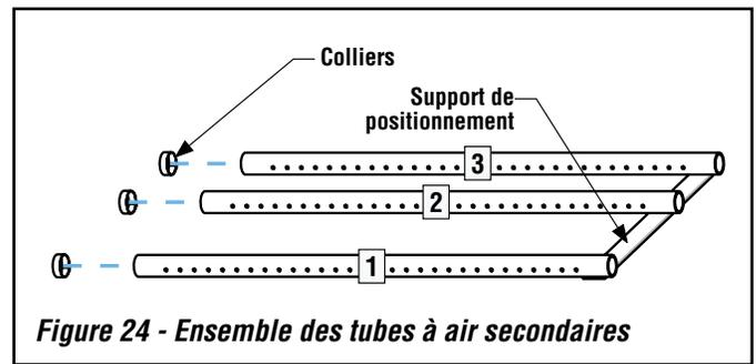
Figure 24 - Ensemble des tubes à air secondaires
