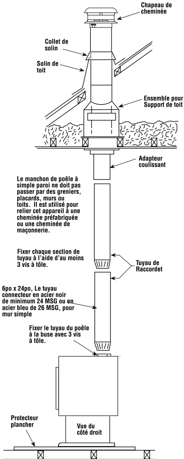
Le manchon de poêle à simple paroi ne doit pas passer par des greniers, placards, murs ou toits. Il est utilisé pour relier cet appareil à une cheminée préfabriquée ou une cheminée de maçonnerie.
