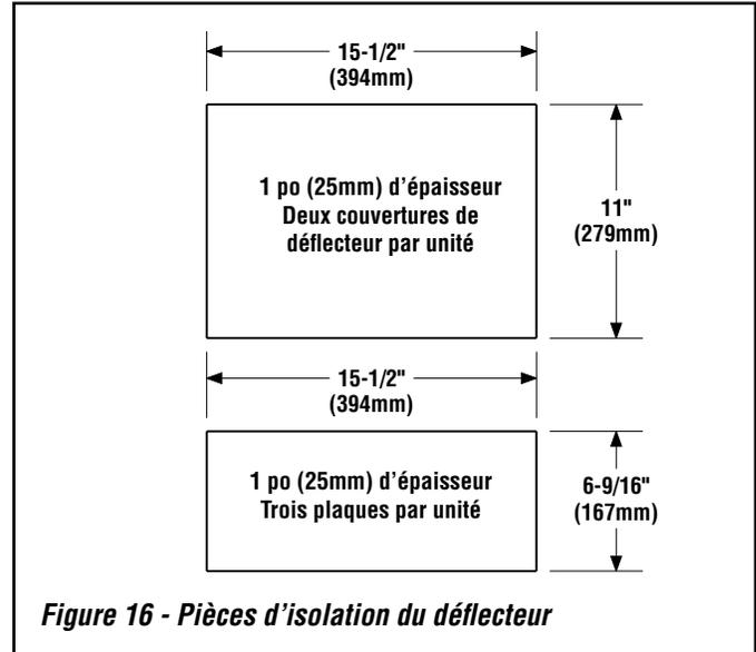
**Figure 16 - Pièces d'isolation du déflecteur**
